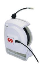
Enrollador de cable eléctrico con carcasa termoplástica de alta resistencia. Diseño compacto de reducidas dimensiones con estructura monobrazo, amplia salida y mínima fricción del cable. Incluye: soporte pivotante de anclaje de serie, cable eléctrico de servicio con el extremo desnudo y disyuntor térmico. Índice de protección IP 44.
