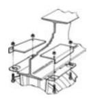
Los enrolladores abiertos y carenados pueden ser montados suspendidos o anclados a una viga, tipo IPN, con ala mínimo/máximo: 100 - 175 mm., sin realizar taladros, utilizando para ellos el juego de 2 soportes con 4 pernos y tuercas de fijación que constituyen este conjunto.
